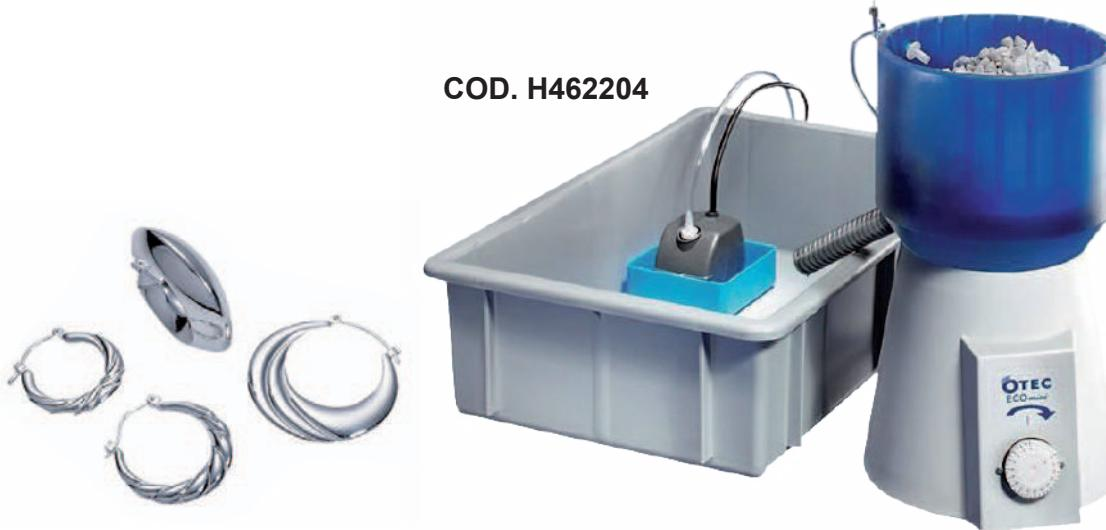
**Applicazioni:** per sbavatura, sgrossatura, lisciatura a umido di oggetti metallici e preziosi. L'utilizzo è particolarmente indicato per oggetti con superfici estremamente deteriorate o colati grezzi.
