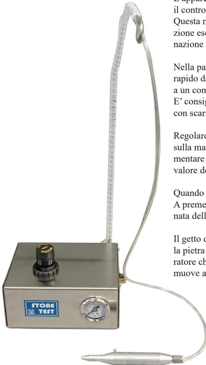
L'apparecchiatura STONE TEST è uno strumento ad aria per il controllo dell'incassatura.
